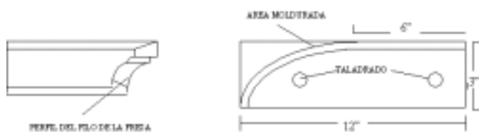
Figura 4. Características de la fresa y de las probetas utilizadas en el moldurado.
