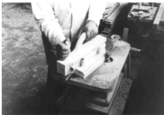
Figura 5. Plantilla y probeta en el proceso de moldurado
