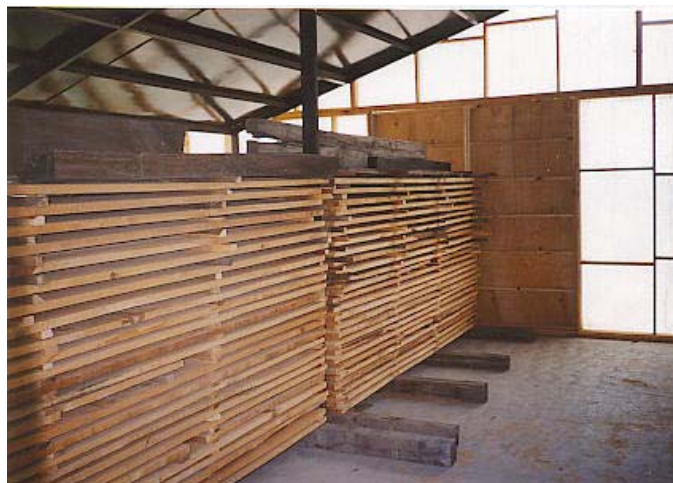
Figura 7. Secador solar con la carga de madera en proceso de secado.
