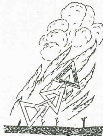
FIGURA 1. El triángulo del fuego es la conexión básica de la reacción en cadena: combustible-oxígeno-temperatura.
