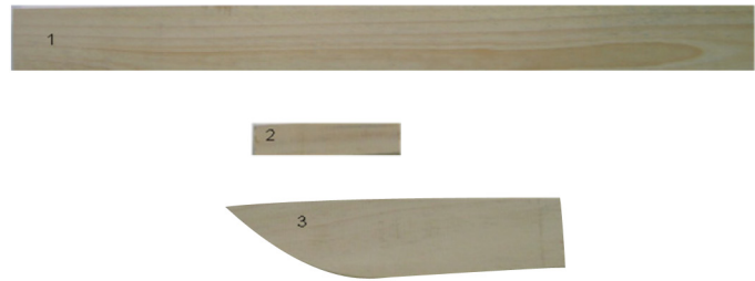
FIGURA 3. Tipos y dimensiones de las probetas utilizadas en los ensayos de trabajabilidad: 1) cepillado y lijado (2 cm x 10 cm x 90 cm o ¾" x 4" x 36"); 2) Torneado (2 cm x 7.5 cm x 30 cm o ¾" x 3" x 12"); 3) moldurado y barrenado (2 cm x 2 cm x 12.5 cm o ¾" x ¾" x 5").
