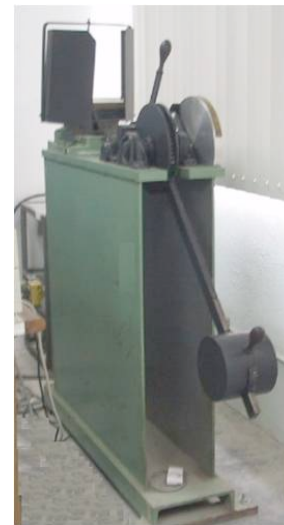
FIGURA 1. Máquina para ensayos de Tenacidad por impacto (Modelo FPL)
